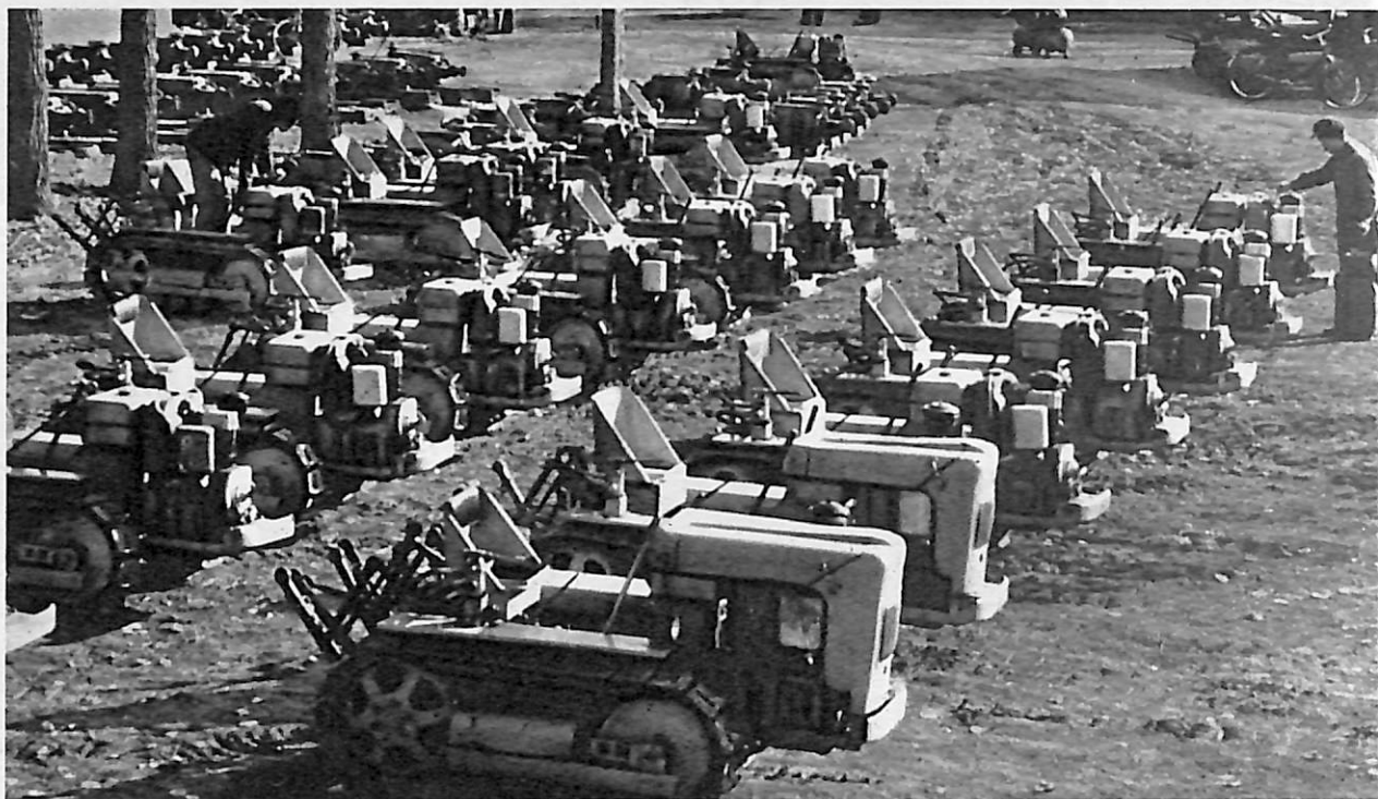
县社大办为农业服务的工业。这是县拖拉机厂自己设计制造的山地用小型履带式拖拉机。
